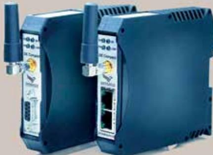
Die DataEagle7000-Module sind jetzt in den Schutzarten IP 20, IP 67 sowie in einer ex-geschützten Ausführung erhältlich.
